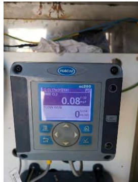
ภาพที่ 2-6 ตัวอย่างภาพถ่ายเครื่องตรวจวัดอุณหภูมิและความเข้มข้นคลอรีนแบบอัตโนมัติของน้ำทิ้ง จากรางระบายน้ำทิ้งของโครงการ
